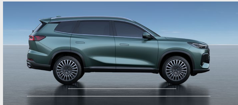
Długość całkowita: 4725 mm, rozstaw osi: 2710 mm
